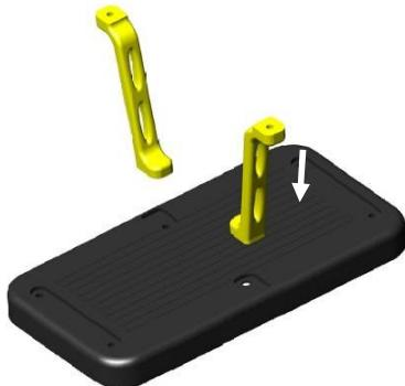
Incastrare i Fermi centrali sugli appositi spazi facendo attenzione a non usare troppa forza (per evitare rottura del piolino)
